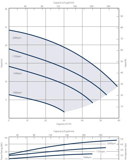
2.0 1750rpm 1500rpm 1.0 1000rpm 20 30 40 50 Capacity (m<sup>3</sup>/h)
